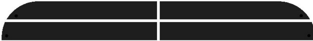
Rysunek 3. Matryca RC-2-2, 2 rzędy elektrod po 2 w każdym.
