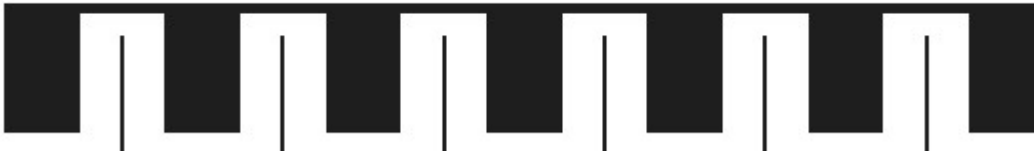
Rysunek 4. Matryca SM-6-1, matryca typu slider do aktywnego badania pojemności elektrod z wykorzystaniem układu AD7142.
