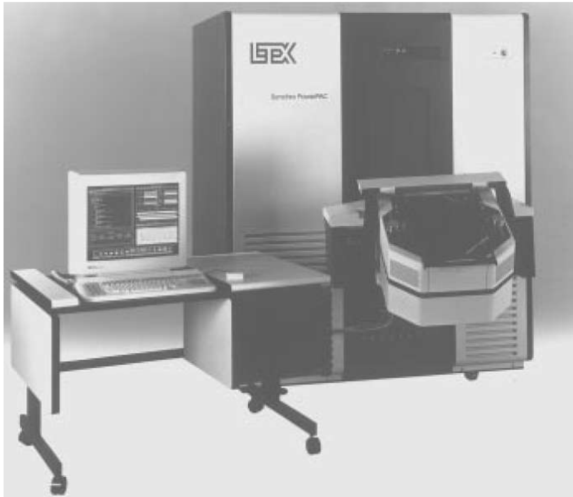
Rys. 25.4. System ATE LTX Syncho (na lewo), interfejs połączeniowy DIB Teardyne A580 (na prawo),
