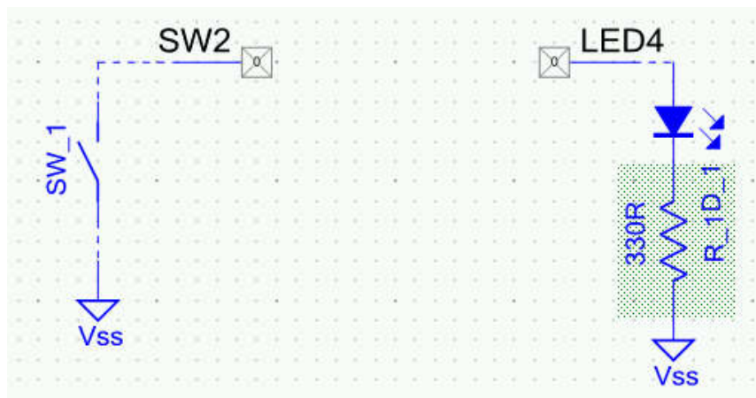
Rys. 7. Schemat wprowadzony w kolorze niebieskim oznacza elementy zewnętrzne w stosunku do układu PSoC 5LP.
